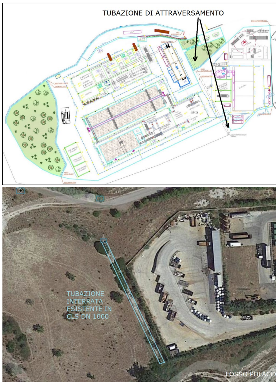
Figg.6 e 7 - Posizione tubazione di scarico acque meteoriche provenienti da monte
