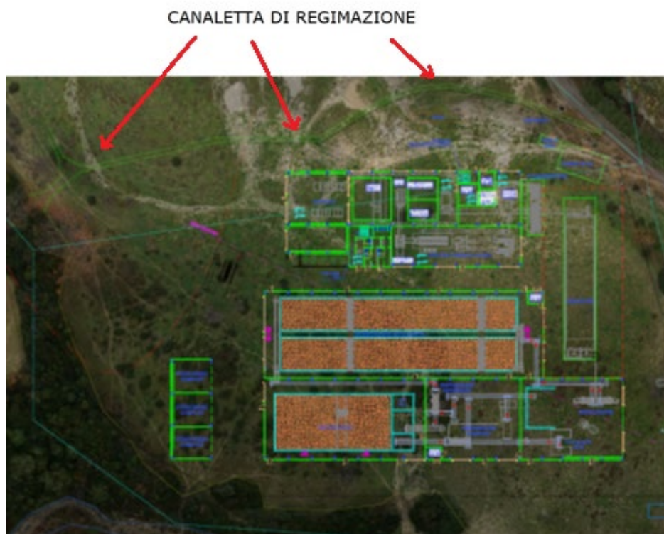
Fig. 2 e 3 – Posizione della canaletta di regimazione parallela al perimetro Nord e Nord-Ovest
